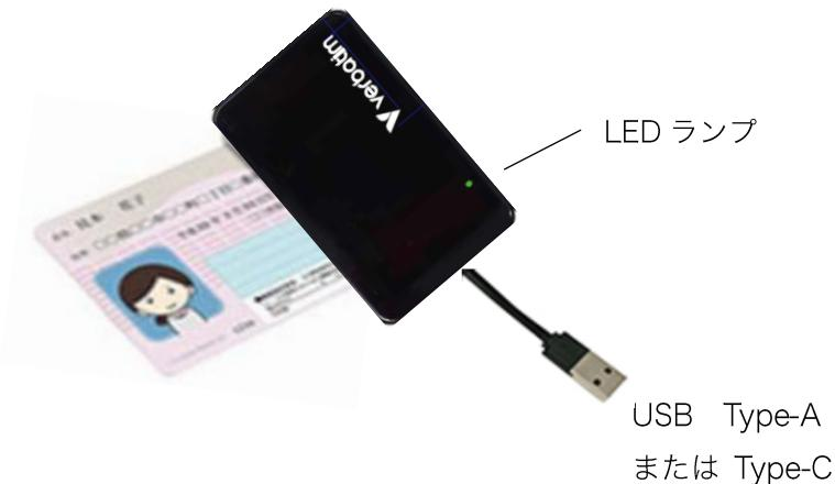
本製品の LED ランプが見えるように設置した状態で、
